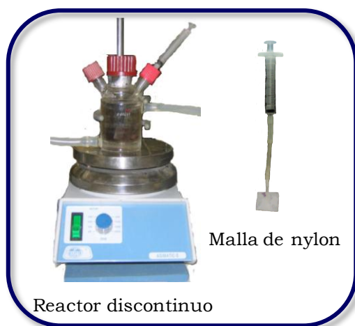
Figura 3.12. Reactor tanque, con dispositivo de toma de muestra.
