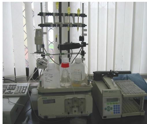
**Figura 13. Imagen de un sistema de FPLC (Biorad).**
