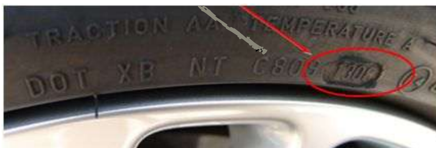
Figura nº7: indicaciones de los neumáticos, referentes a la semana y año de fabricación.
