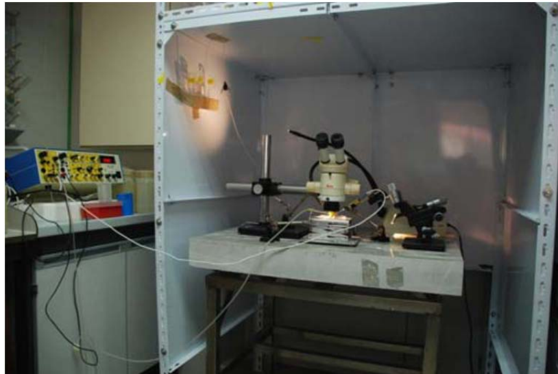
Figura 3.6. Cabina de Faraday en la que se llevaron a cabo los registros de potencial de membrana con microelectrodos simples.
