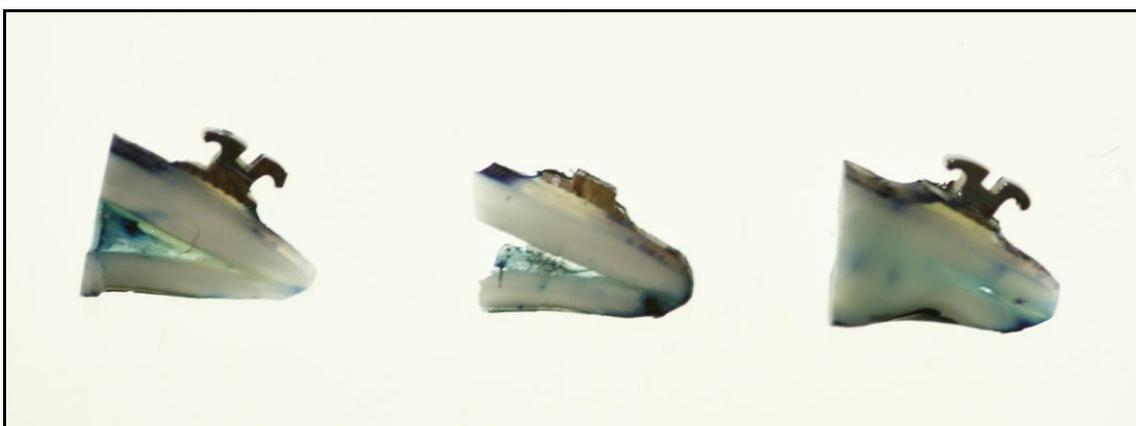
Figura 10. Detalle de las 3 secciones realizadas a cada espécimen.
