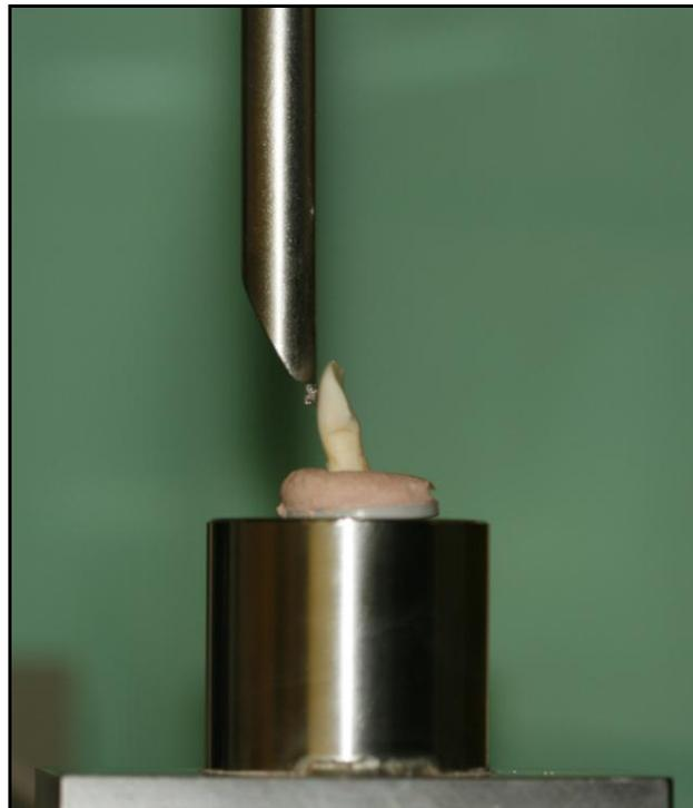
Figura 5. Detalle del vástago incidiendo sobre el bracket.
