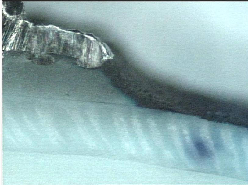
Figura 16. Microfiltración en la interfase adhesivo-bracket a 100 aumentos de un espécimen del grupo Coca-Cola®.
