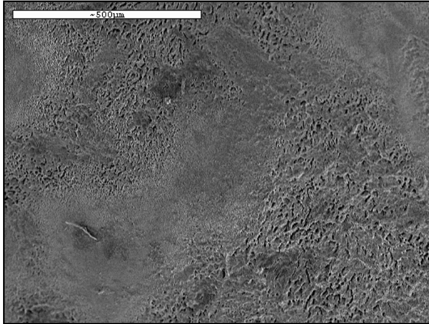
Figura 21. Imagen de MEB del grupo Coca-Cola® con esmalte intacto x 100.
