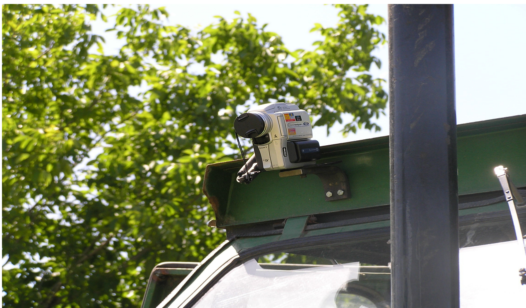
Figura 2: Anclaje del dispositivo a la carrocería del tractor.
