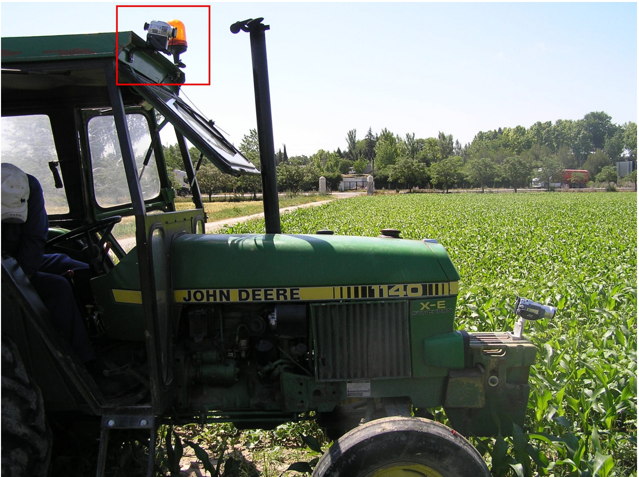
Figura 1: Posición del dispositivo de captura de vídeo.
