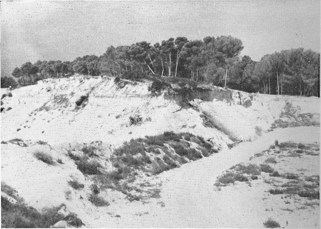
Sa Barrala: explotación de arena eólica en el camino de Ses Covetes. Obsérvese el corte de la duna reciente y de los mantos arenosos subyacentes
