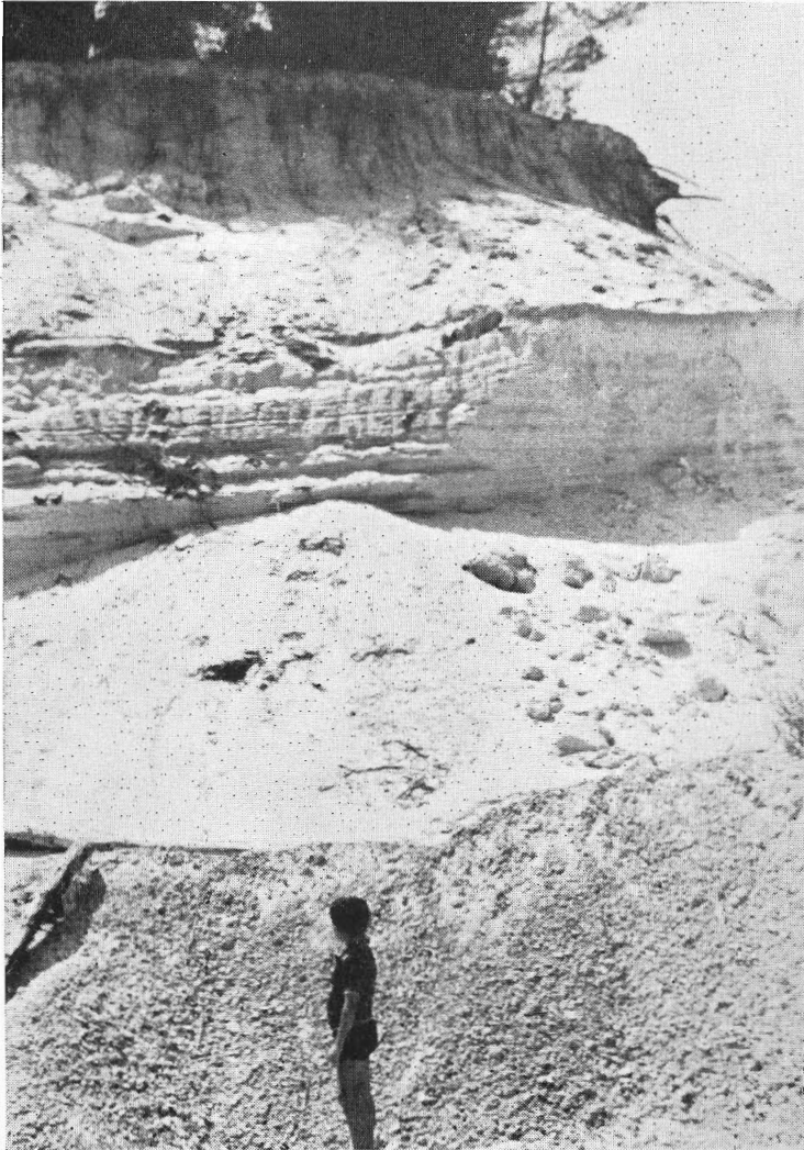
Sa Barrala: explotación de arena eólica destinada a la construcción. Bajo la duna cubierta de vegetación y suelo inicial, se aprecia un horizonte estratificado y algo consolidado
