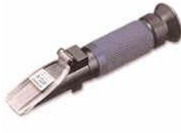
**Figura I.1.4.2.2.** Refractómetro
