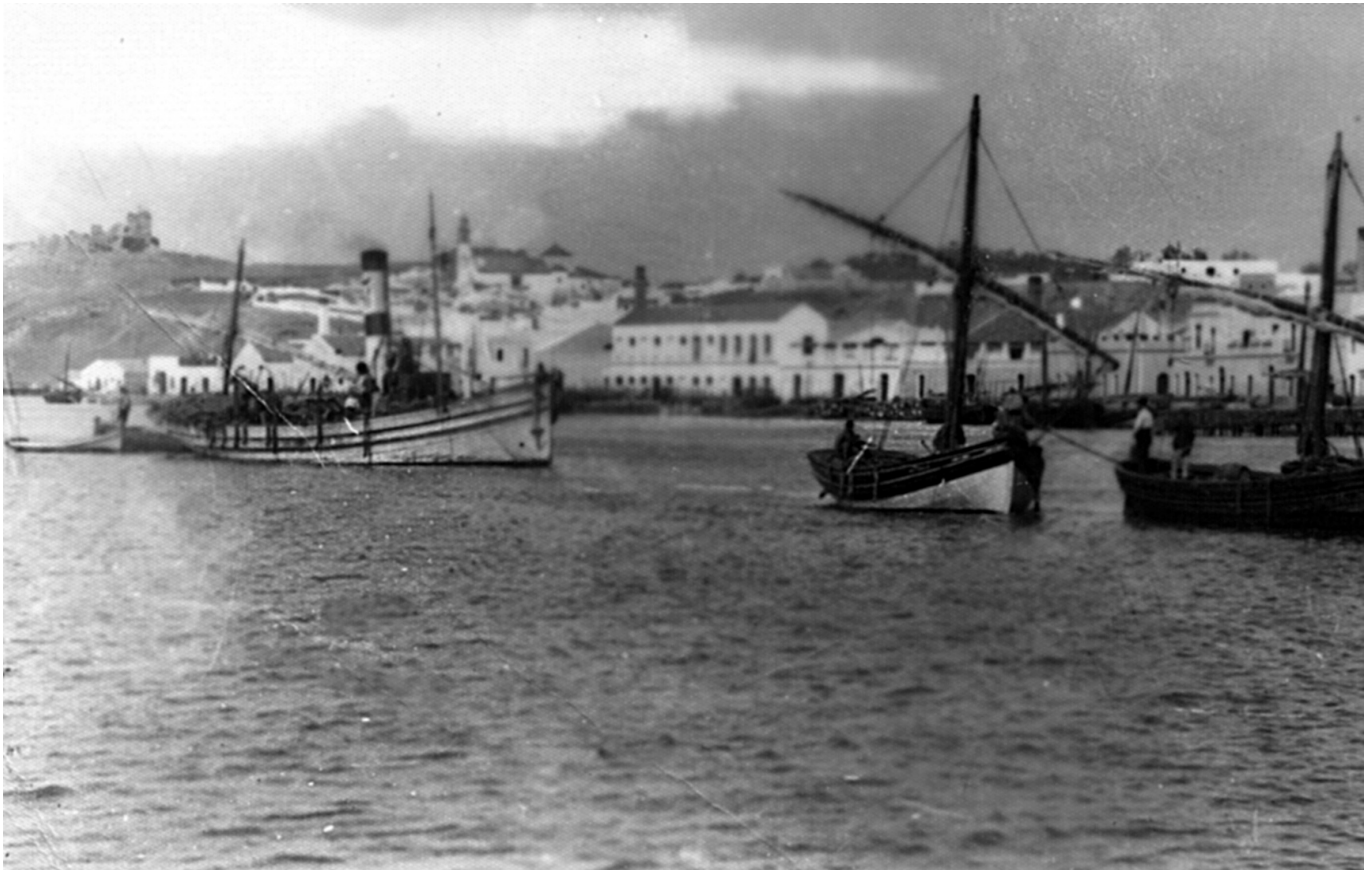
Tarrafa de la costa occidental de Huelva en los años veinte del pasado siglo compuesta por un vapor tarrafero que transporta la red, y varias embarcaciones acostadas movidas a vela cuya misión era la de ayudar a calar la red y enviar la sardina a la lota.
