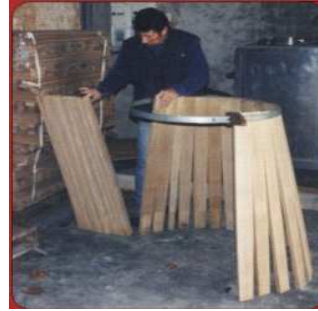
2. Armado de la barrica
