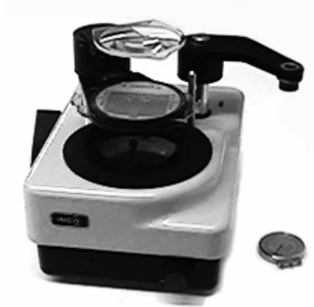
**Figura 10.4.** Centrador de lentes *Indoblock*. A la derecha, un esferómetro.
