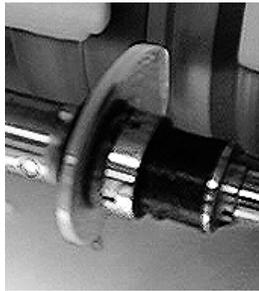
**Figura 11.3.** Tras el desbaste, se pasa al proceso de realización del bisel, con un tipo de muela que a la vez afina el borde. Si el bisel es en “v” puede elegirse la realización de su recorrido de forma automática (bisel automático) o manualmente (bisel guiado)
