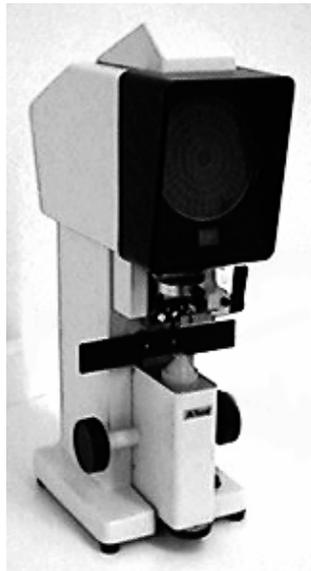
**Figura 4.1.** Frontofocómetro de proyección. Existen otros modelos, como pueden ser los que tienen ocular (los más comunes), automáticos, etc.
