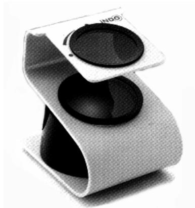
**Figura 5.2.** Tensiscopio del laboratorio, de Indo. La montura se debe situar entre los dos polarizadores lineales. El polarizador superior se puede girar 90°.
