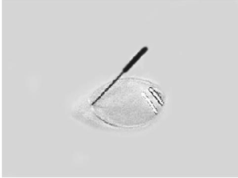
Para agrandar y limpiar el orificio, se puede usar una broca de mayor sección o utilizar un escairador (imagen). Al taladrar lentes de policarbonato suelen quedar restos de material en el borde del orificio, que hay que quitar con mucho cuidado para no rayar la lente.
