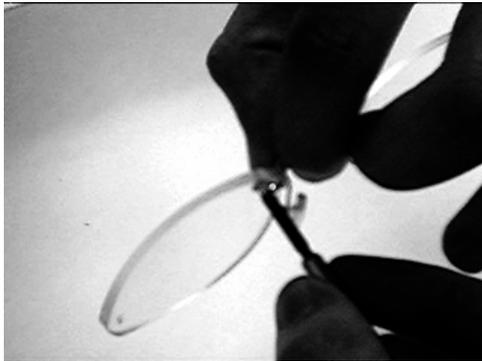
Antes de montar las gafas, conviene pulir el borde de la lente. Después se colocan en orden los componentes de la sujeción: camisas de plástico, arandelas, tornillo, el puente (imagen) o la varilla, y por último se aprieta la tuerca con un destornillador especial.
