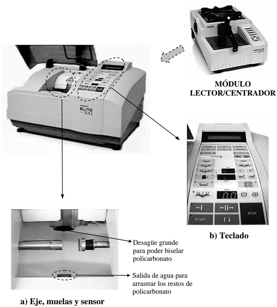
Figura 11.16. Biseladora Élite XXI y módulo lector/centrador Indoform CNC.
