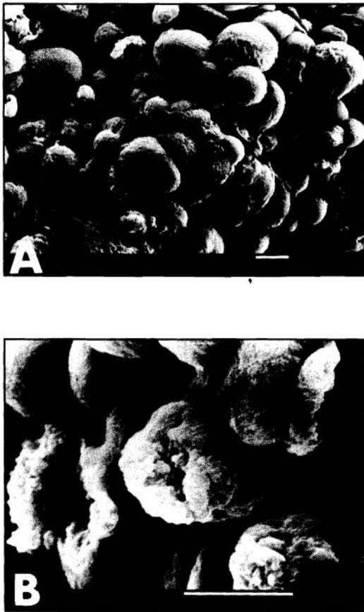
FIGURA 4. Micrografías electrónicas de barrido obtenidas en muestras de bolas de k-carragenina inoculadas con *E. coli* K12/pTG201 cultivadas en presencia de 21% de oxígeno después de 24 horas de cultivo. (Las barras representan 10  $\mu\text{m}$ .)
