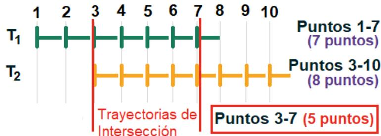
FIGURA 4.2. Representación temporal de la trayectoria de intersección entre dos trayectorias.
