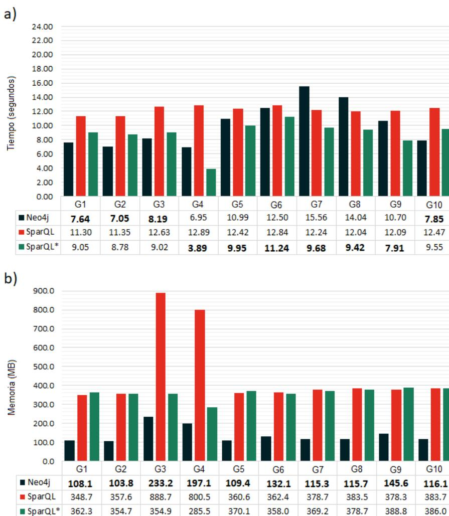
FIGURA 3.10. B3. CE5. Comparativa de entre Neo4j, GraphDB para RDF y GraphDB para RDF\* en la ejecución de CE5 en los grafos G1 a G10. a) Comparativa del tiempo en segundos. b) Comparativa de la memoria en MB. Hemos marcado en negrita el valor más pequeño para cada conjunto de datos.
