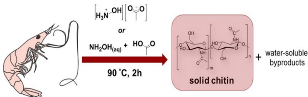
Figura 1. 17 Esquema de extracción de quitina de residuos biológicos mediante pretratamiento con líquidos iónicos, obteniendo de quitina de alta pureza. Adaptado de la ref. 243 (Copyright 2016 American Chemical Society).
