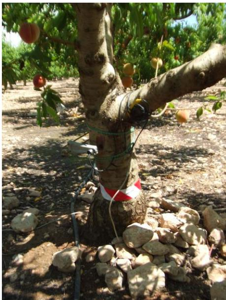
**Fotografía 3.6.** Dendrómetro instalado en el tronco de un melocotonero.
