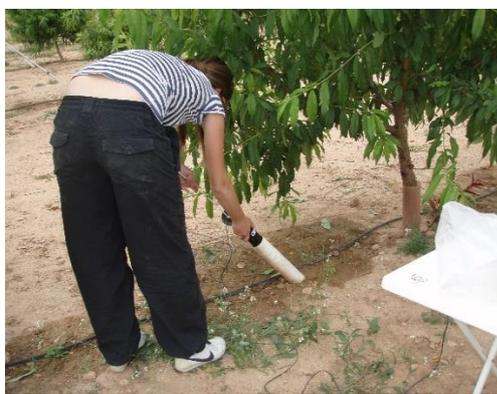
**Fotografía 3.5.** (A) Minirizotrón antes de su instalación en el suelo (1,4 m tubo transparente + 0,4 m blanco), (B) Equipo perforador durante la instalación, (C) Escáner circular, (D) Equipos para la medida de raíces en campo: minirizotrón, escáner con varilla, ordenador portátil, (E) Medida de DLR en el suelo de un nectarino.
