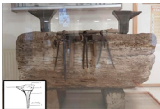
Figura 2. Fotografía del banco de herrar expuesto en el vestíbulo de la FVTUM y esquema de la bigornia (Hernández Roca, 2004): 1) Cara superior o mesa; 2) Cara anterior; 3) Cara lateral izquierda o cuerna; 4) Cara lateral derecha o talón; 5) Espiga.
