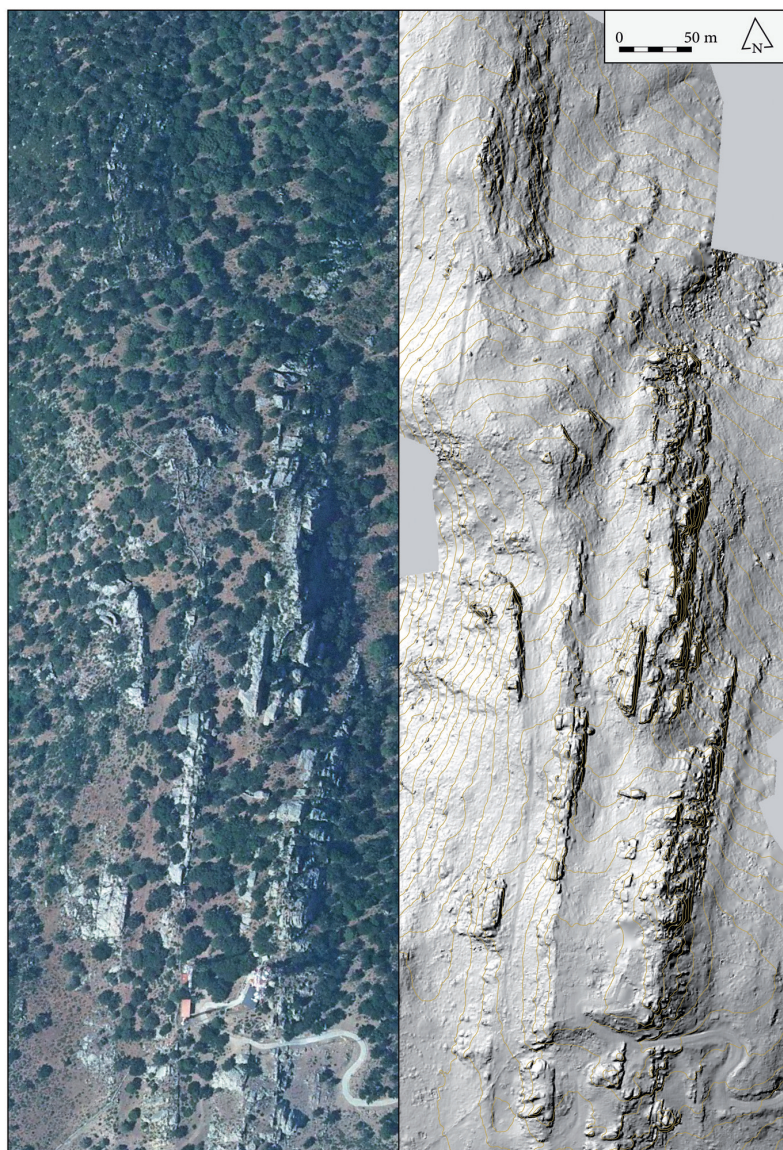
FIG. 1. — Topografía del yacimiento de la Silla del Papa según la ortofoto del Instituto Geográfico Nacional (izquierda) y según el modelo digital de terreno generado a partir de datos Lidar obtenidos con un dron (derecha)
