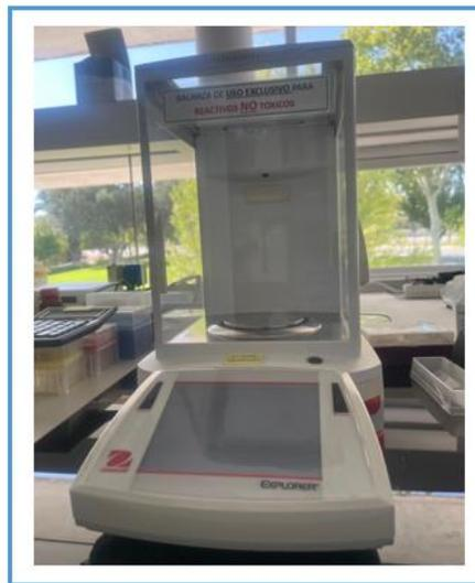
**Figura 6.** Balanza electrónica de precisión (Explorer™ analítica, OHAUS, Nänikon, Suiza).
