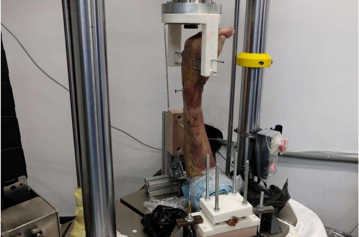
Figura 38. Montaje y fijación de la pieza cadavérica en el motor
