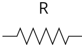
Figura 12. Representación de una resistencia lineal
