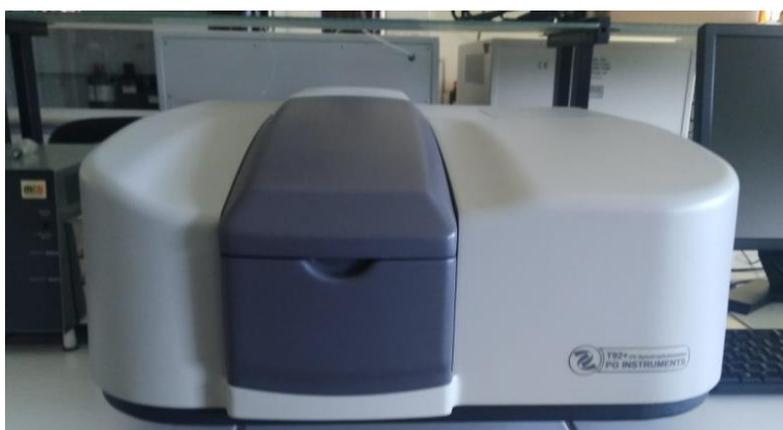
**Figura 1.14.** Espectrofotómetro T92+ para la medición de espectros UV-vis.
