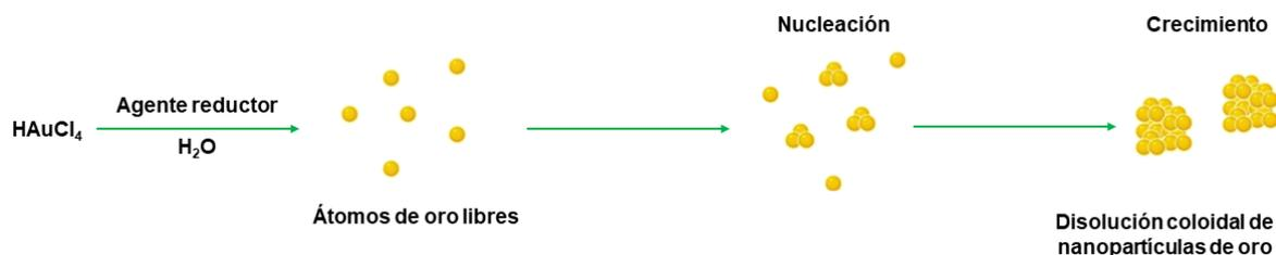
**Figura 1.2.** Esquema de la síntesis de nanopartículas de oro por reducción de una sal de oro (procedimiento “abajo-arriba”).
