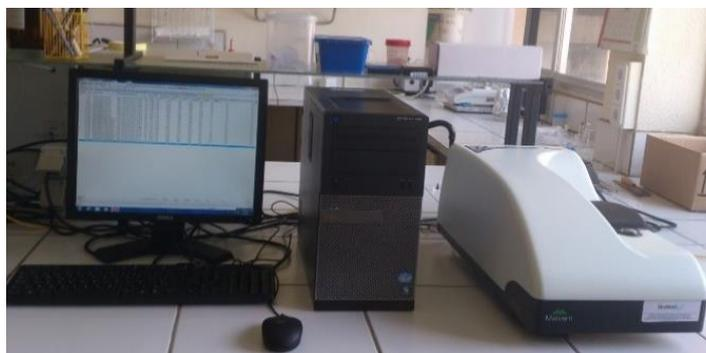
**Figura 1.10.** Equipo Zetasizer Nano-ZS de Malvern utilizado.
