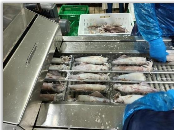
**Figura 49.** Túnel de nitrógeno empleado para ultracongelar el calamar envasado al vacío
