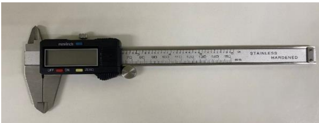
Foto 22: Instrumento Caliper Vernier
