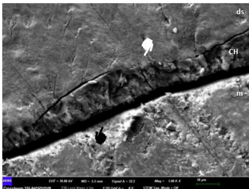
Figura 32. Grupo IVAb (FESEM 1000x) ds: dentina sana; m: material; CH: capa híbrida; marcador blanco: adhesión en la interfase; marcador negro: no adhesión en la interfase
