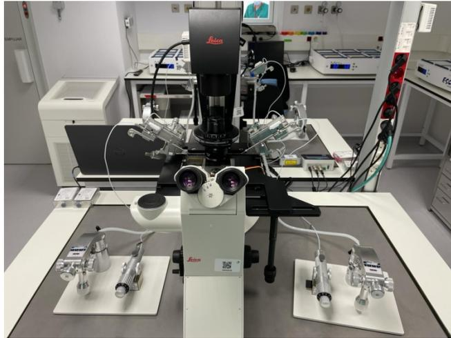
Figura 28. Microscopio invertido, con micromanipulador y microinyector.
