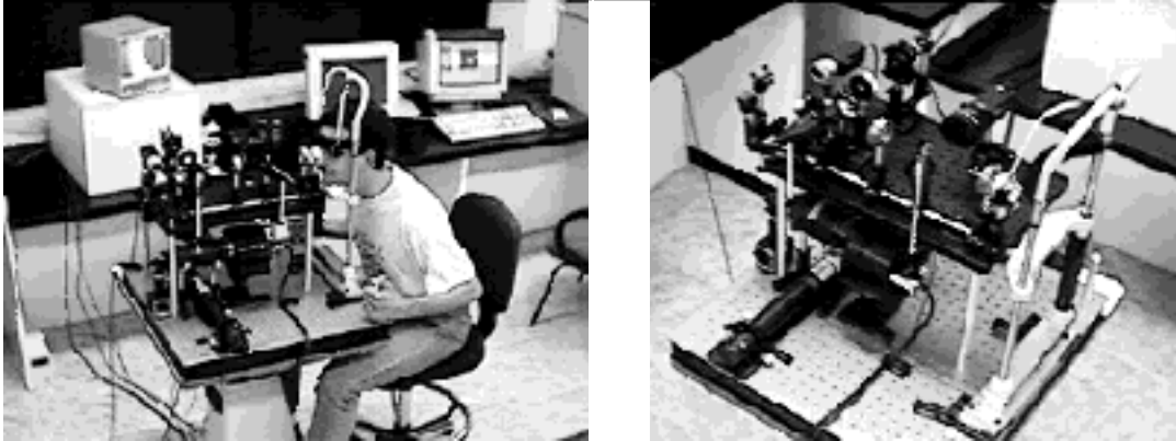
Figura 2.1-4: Fotografías del sistema de doble-paso construido. El aparato se dispuso en dos alturas para resultar más compacto y similar a los dispositivos habituales en un entorno clínico.
