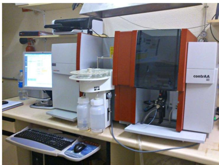
*Figura 3.22.- Contra AA700: Espectrómetro de absorción atómica en llama.*
