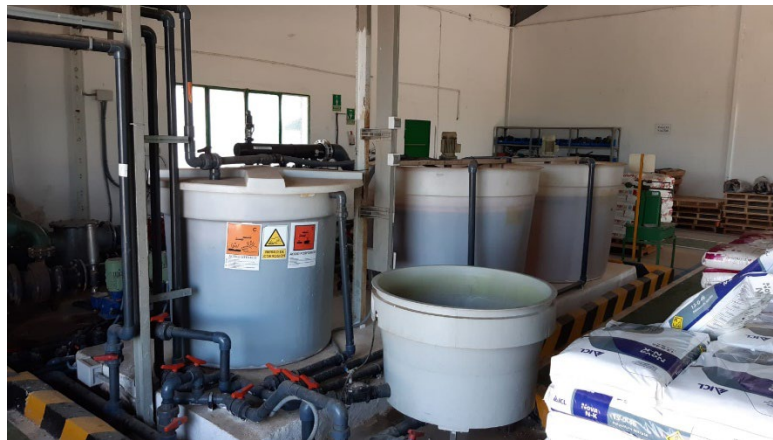
Figura 2.3.2. Moderno cabezal de riego donde se aplica la fertirrigación
