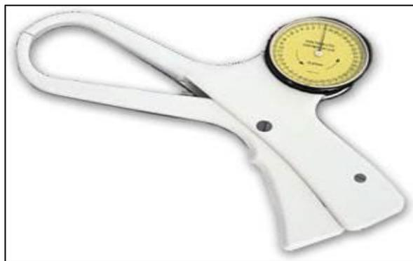
**Figura 13.** Plicómetro o compás de pliegues cutáneos tipo Harpenden.
