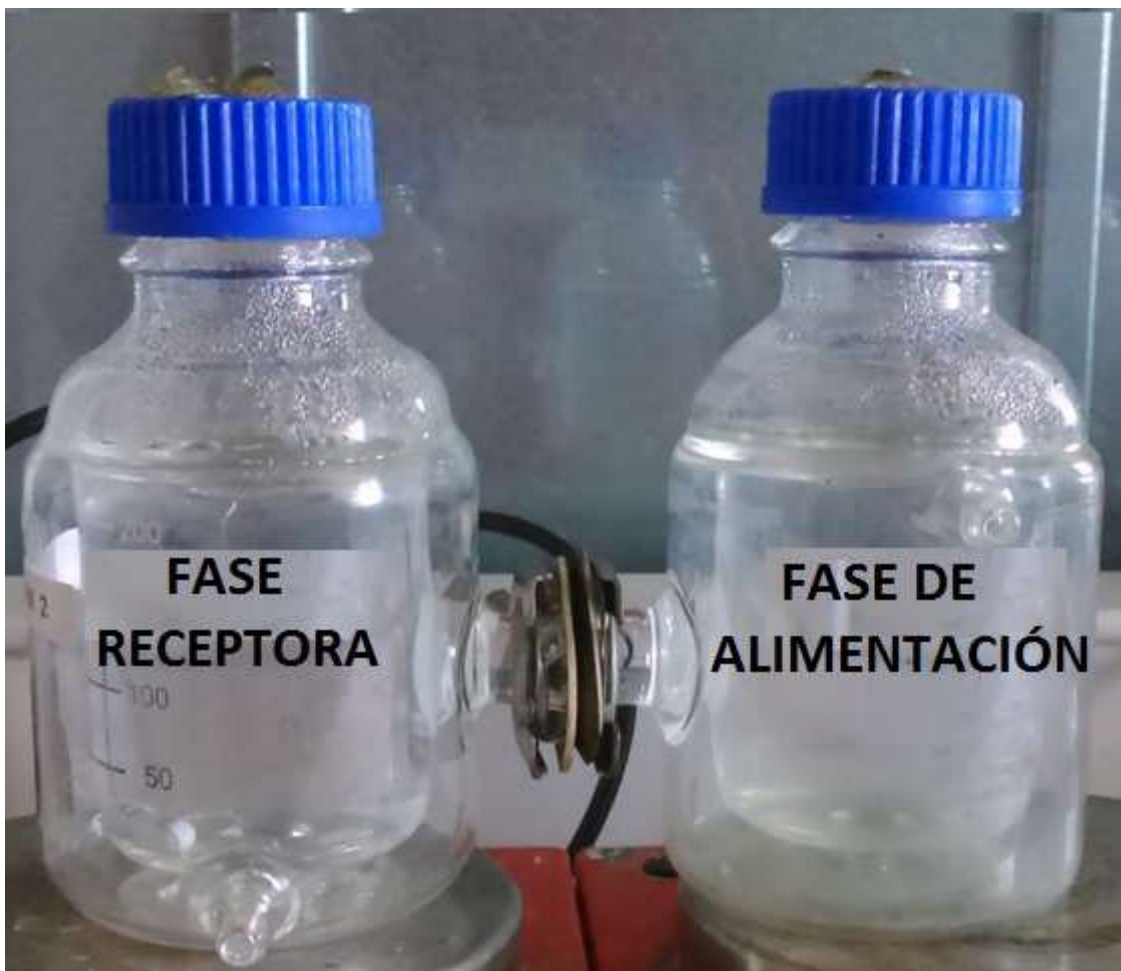
Figura 4.2. Célula de difusión empleada en estudios de transporte de nutrientes.
