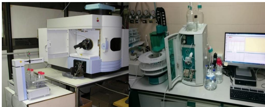
Figura III.9 Equipo de espectrometría de emisión con Plasma Acoplado Inductivamente ICP-iCAP 6500 Duo Thermo y Cromatógrafo iónico Metrohm. Fuente: sstti.ua.es.
