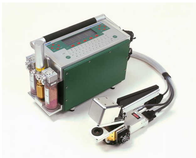
Figura II. 17 Medidor portátil de fotosíntesis y otras variables fisiológicas como conductividad estomática y transpiración. Fuente: www.licor.com
