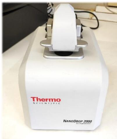
**Figura 4.33.** Dispositivo *NanoDrop 2000* (Thermo Scientific). Imagen tomada en nuestro laboratorio.
