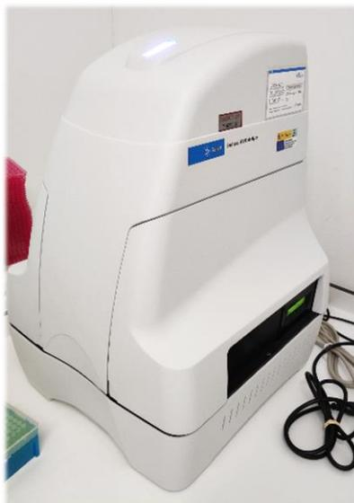
**Figura 4.16.** Dispositivo *Seahorse XFe96 Analyzer* (Agilent Technologies). Imagen tomada en la Sección de Cultivo de Tejidos de la UM.
