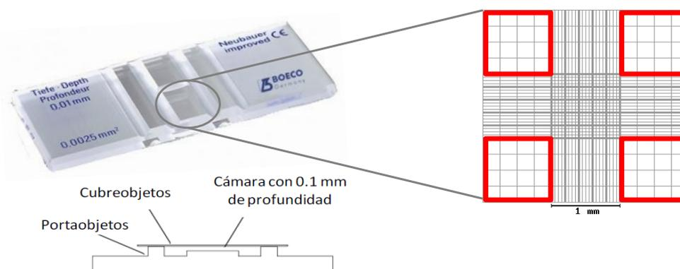
**Figura 4.7.** Imagen y esquema de una cámara de Neubauer. Se muestra una ampliación de la retícula cuadrangular con los cuadrantes donde se realiza el recuento celular señalados en rojo.
