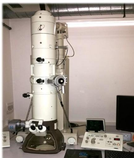
**Figura 4.12.** Microscopio electrónico de transmisión *JEOL 1011*. Tiene acoplado una cámara digital de alto contraste *GATAN ORIUS SC200*. Imagen tomada en el Servicio de Microscopía de la UM.
