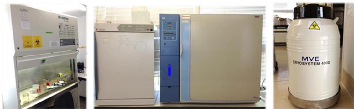
**Figura 4.1.** Cabina de flujo laminar, incubadores y depósito de nitrógeno líquido (de izquierda a derecha). Imágenes tomadas en la Sección de Cultivo de Tejidos de la UM.
