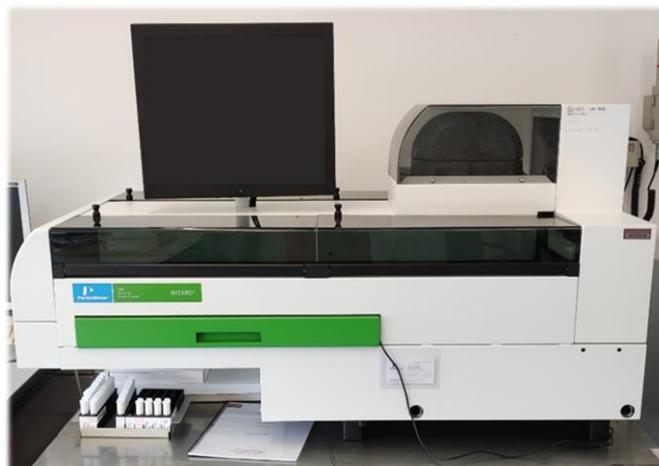
**Figura 4.19.** Contador de centelleo gamma *Wizard2 2480* de Perkin Elmer. Imagen tomada en la Sección de Radioprotección y Residuos de la UM.
