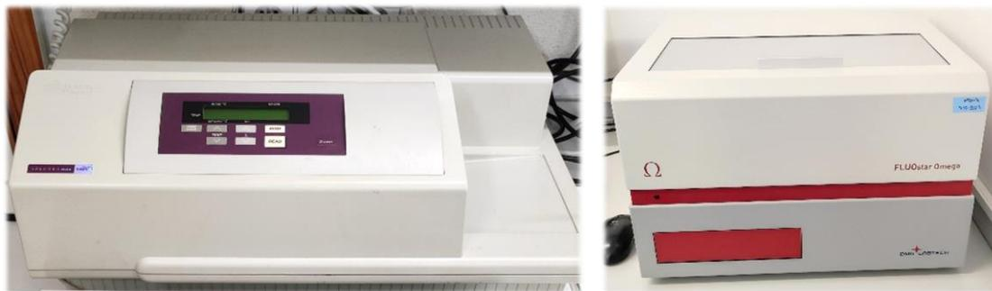
**Figura 4.27.** Lectores de placas *SpectraMax 340PC384* de Molecular Devices (izquierda) y *FLUOstar Omega* de BMG LabTech (derecha). Imágenes tomadas en nuestro laboratorio y en la Sección de Cultivo de Tejidos de la UM.
