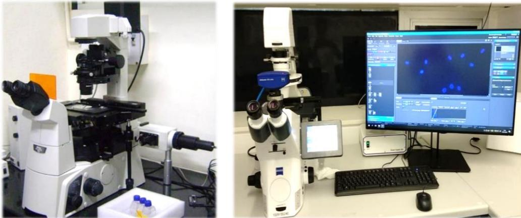
**Figura 4.10.** Microscopios ópticos invertidos *Nikon-Eclipse TE-2000U* (a la izquierda) y *Zeiss Axio Observer 7* (a la derecha). Ambos microscopios están acoplados a un módulo de fluorescencia y fotografía. Imágenes tomadas en la Sección de Cultivos de Tejidos de la UM.
