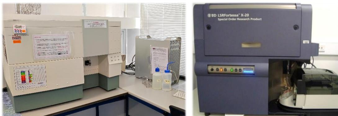
**Figura 4.14.** Citómetros de flujo *FACSCalibur Cell-Quest* (izquierda) y *BD LSRFortessa X-20* (derecha). Imágenes tomadas en la Sección de Cultivo de Tejidos de la UM.
