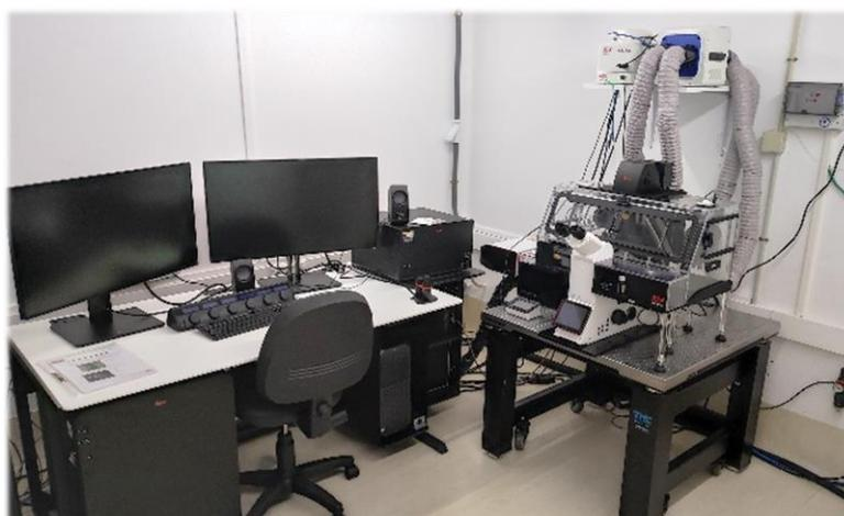
**Figura 4.11.** Microscopio de barrido láser confocal *Leica STELLARIS 8* (Leica Microsystems). Imagen tomada en la Sección de Microscopía de la UM.
