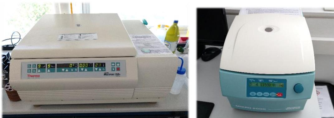
**Figura 4.24.** Aparatos de centrifugación. Centrífuga Heraeus Multifuge 3SR+ (izquierda) y microcentrífuga Hettich mikro 200R (derecha). Imágenes tomadas en la Sección de Cultivo de Tejidos de la UM.
