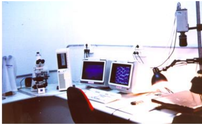
Figura 12. Microscopio OLYMPUS BX40 (vista lateral) y estación de análisis morfológico utilizando análisis de imágenes para la identificación de células binucleadas (BN) y binucleadas con micronúcleos (MNBN).
