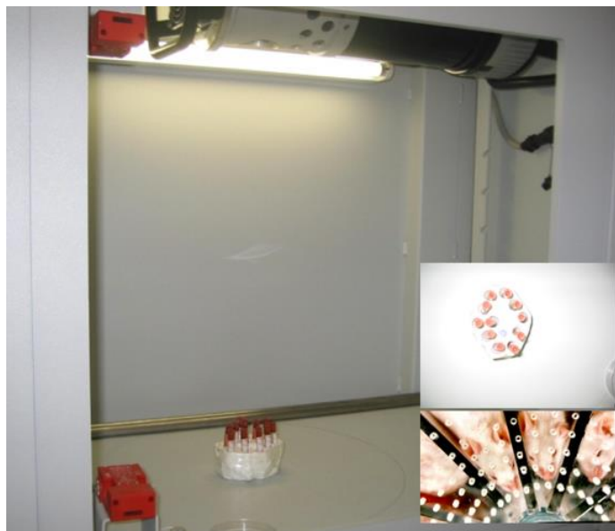
Figura 25. Detalle de la cabina en el interior del equipo de rayos X. Obsérvese la colocación de los animales inmovilizados y conscientes para una irradiación corporal total; y, la colocación de las muestras sanguíneas durante la exposición a rayos X.
