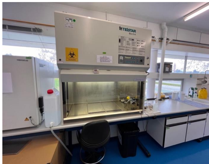
Figura 7. Cabina de flujo laminar usada para la manipulación de cultivos y muestras biológicas.
