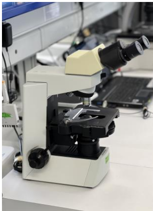
Figura 12. Microscopio OLYMPUS BX40 (vista lateral) y estación de análisis morfológico utilizando análisis de imágenes para la identificación de células binucleadas (BN) y binucleadas con micronúcleos (MNBN).
