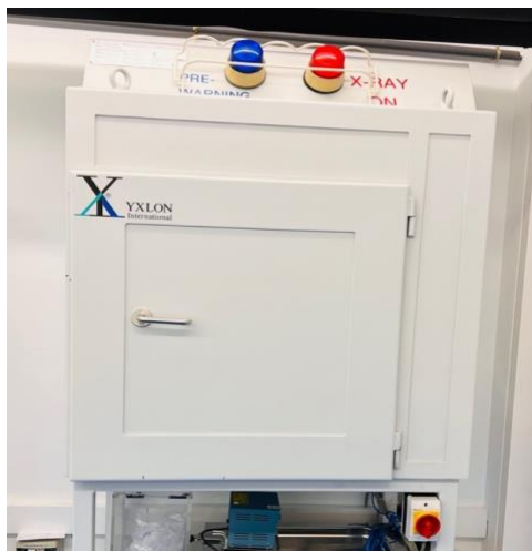
Figura 8. Equipo de rayos X utilizado: Smart Laboratory-ray, Model 583 E.
