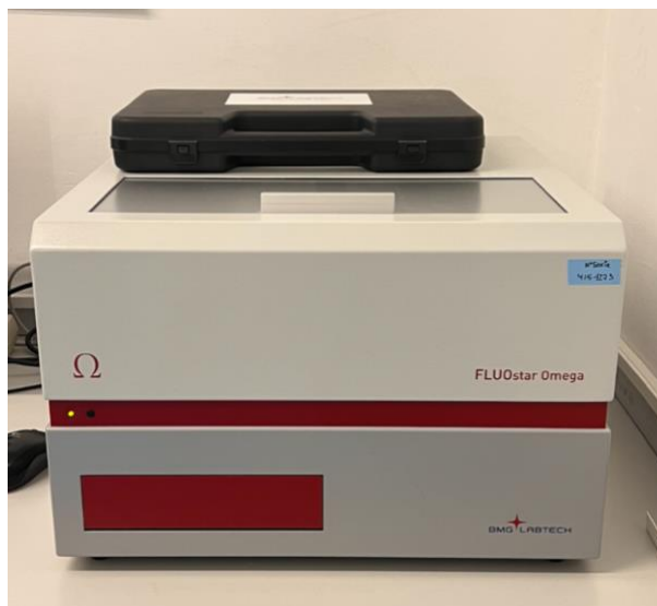
Figura 18. Espectómetro FLUOstar® Omega para medida de la absorbancia.
