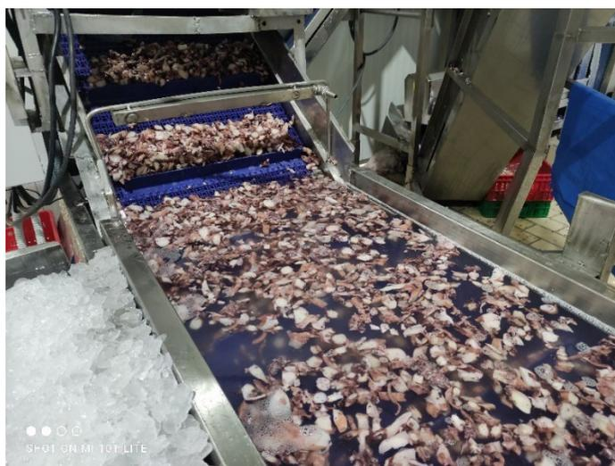
Se realizaba un control del glaseado del producto final. Se controlaba que la temperatura del glaseador permaneciera a 0 °C, que la temperatura del túnel de congelación fuera correcta y que el glaseado se ajustara a las especificaciones del producto.
