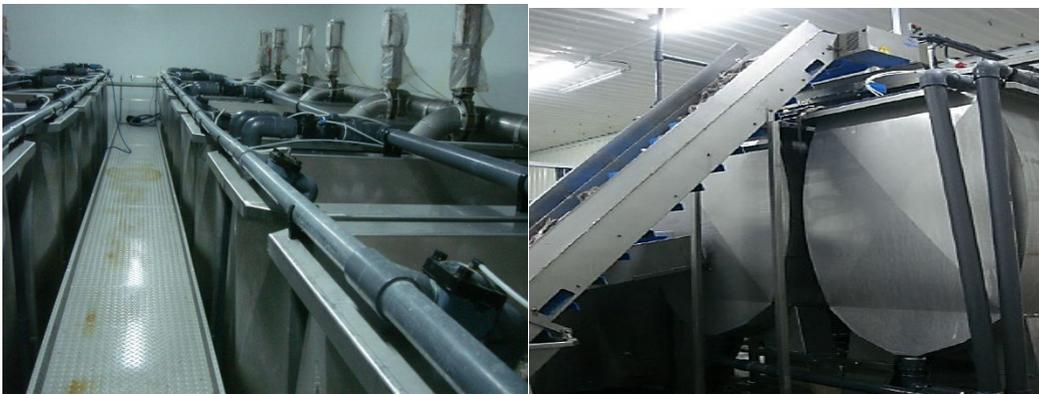
Para un correcto control de esta etapa, se disponía de un sistema automático de llenado de agua para calcular exactamente el volumen de agua necesario (**figura 35**), un sistema de inyección de aire jacuzzi, y un sistema de apertura de válvula de salida de producto por compuerta neumática.
