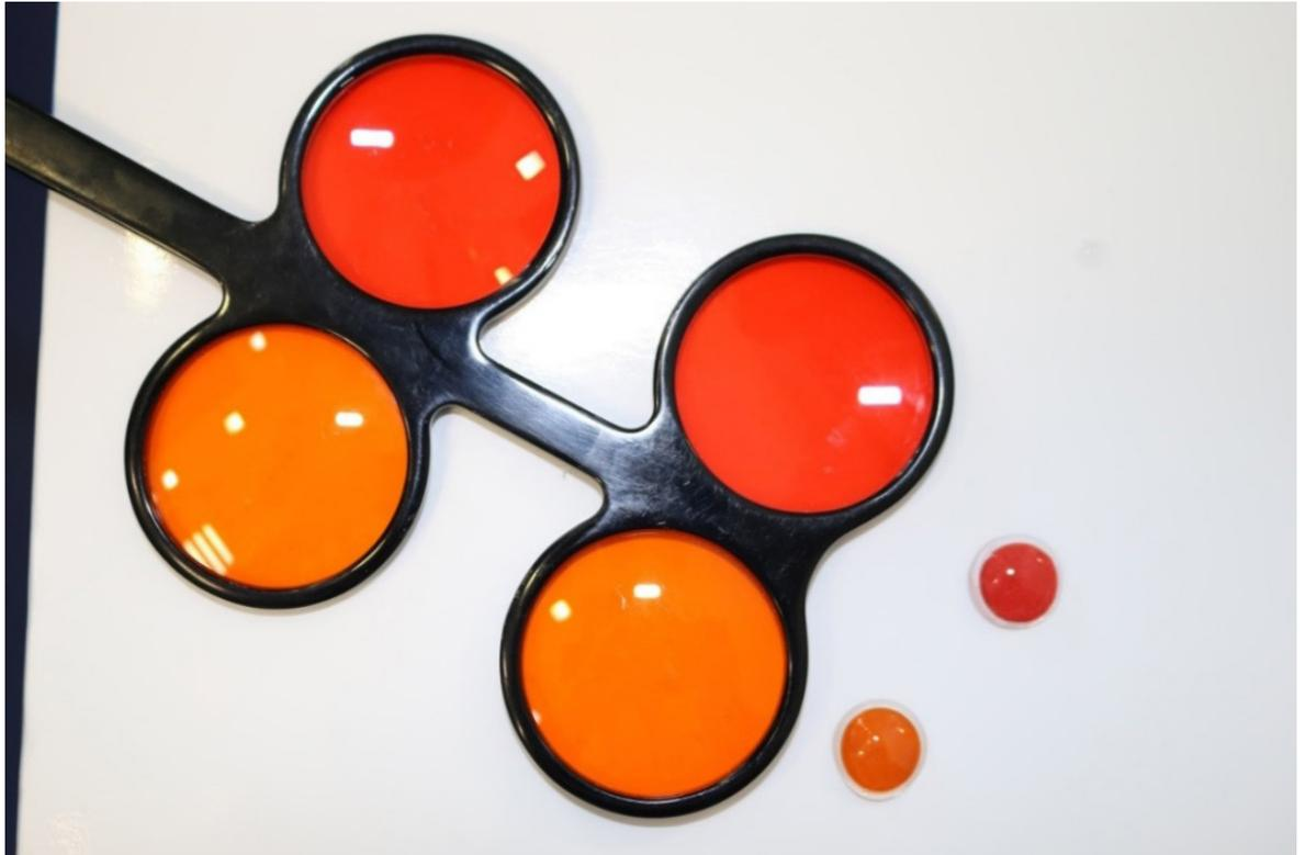
**Figura 28.** Filtros oftálmicos montados en flipper y lentes de contacto tintadas de color e intensidad similar.
