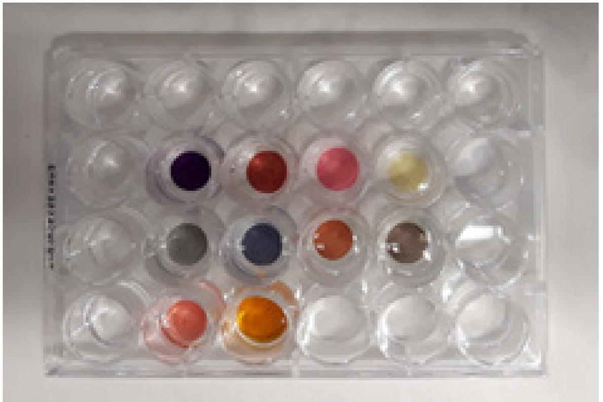
**Figura 33.** Cubeta con solución salina y distintas lentes de contacto pintadas para analizar en el espectrofotómetro. *Fuente: creación propia.*
