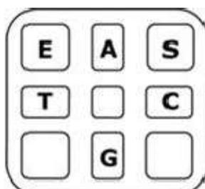
**Figura 23.** Ilustración del cartucho PyroMark Q24 (visto desde arriba): mezcla de enzimas (E), mezcla de sustrato (S) y los nucleótidos (A, T, C, G). (Imagen tomada del manual: theascreen® KRAS Pyro® Kit Handbook, 2015).
