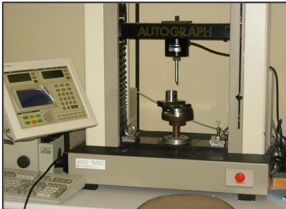
**Figura 19.** Máquina Universal de Ensayos tipo Autograph AGS-1KND. Unidad Docente de Ortodoncia de la Universidad de Murcia.
