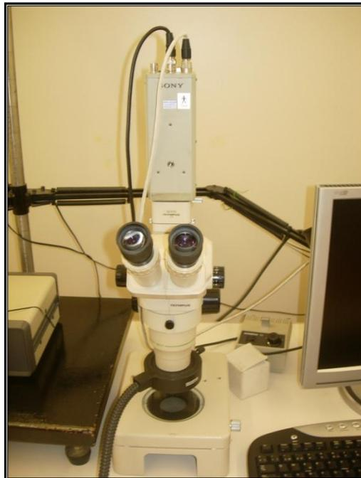
**Figura 22.** Vídeo Cámara Sony dxc 151-ap conectada al Microscopio Olympus SZ11 utilizado para obtener la imagen del adhesivo remanente en la base del bracket. Servicio de Análisis de Imagen del Servicio de Apoyo a la Investigación (SAI) de la Universidad de Murcia.
