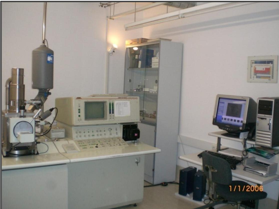
**Figura 28.** Microscopio Electrónico de Barrido tipo Jeol 6100 y equipo informático utilizado para la digitalización de imágenes. Servicio de microscopía electrónica del Servicio de Apoyo a la Investigación (SAI) de la Universidad de Murcia.
