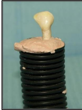
**Figura 17.** Muestra montada en escayola en el cilindro plástico.
