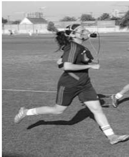
*\*Nota: La Figura 2 muestra el analizador de gases fijado al tronco y cuello a través de un arnés dispuesto por el fabricante del equipo para pruebas de campo.*
