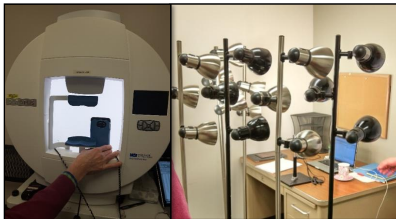
Figura 3.3. Campímetro modificado para emitir diferentes intensidades de iluminancia (izquierda) y entorno de oficina (derecha).
