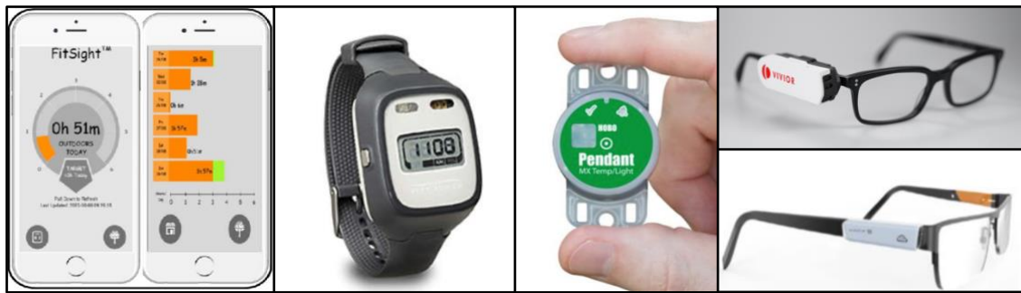
Figura 2.1. Algunos dispositivos de medida objetiva de iluminación ambiental, distancia y tiempo de lectura. De izquierda a derecha: FitSight App ® , Actiwatch ® , HOBO Pendant ® , arriba Vivior ® y abajo Clouclip ® .
