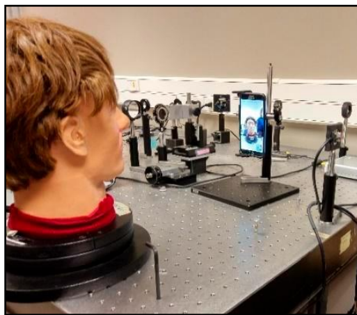
Figura 3.4. Medición de iluminancia facial del maniqué M1 con la cámara de un teléfono móvil Samsung S6 Edge Plus.
