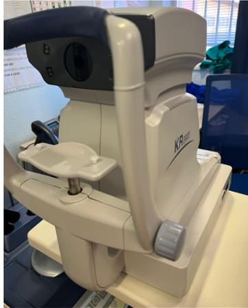
**Figura 2.1.** Autorrefractómetro KR-8900 usado en este trabajo para las medidas de refracción (imagen de elaboración propia).
