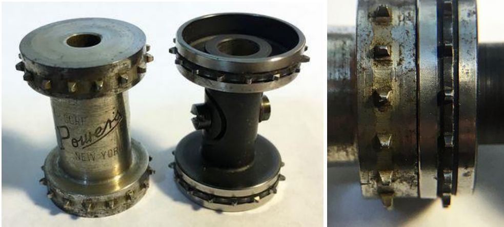
Rodillos de arrastre de película, a la izquierda para perforación estándar, a la derecha perforación Fox.
