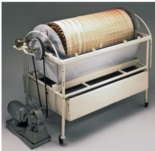
FIGURA 1. El primer riñón artificial. Willem Kolff (1939). Fuente: centro de información de diálisis (93) .
