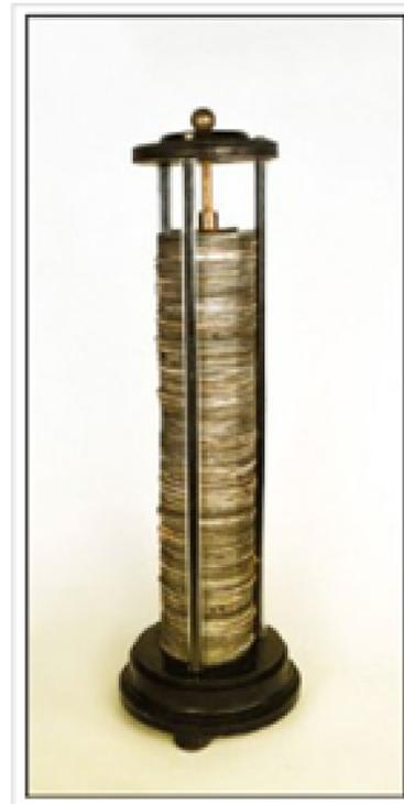
El artilugio que construyó para tal fin era muy voluminoso. Una serie de 30 discos de cobre y cinc apilados alternativamente y separados por discos de cartón empapados en agua salada. Al primer y último disco se unían dos cables a modo de terminales. Una vez cerrado el circuito entre los dos terminales, se tenía una fuente constante de electricidad. ¿Qué sería de la sociedad actual sin la variedad de pilas y baterías que alimentan la infinidad de dispositivos con los que convivimos?
