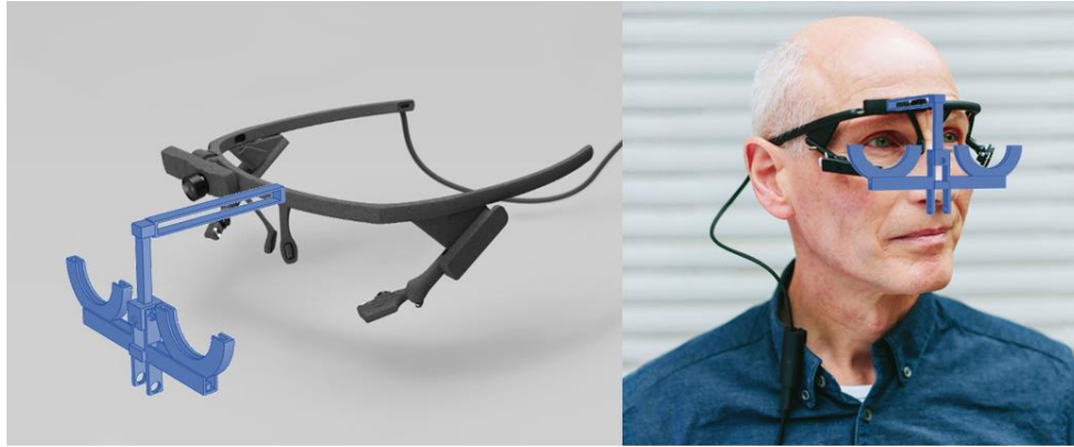
Figura 8. Sistema de soporte de lentes impreso (coloreado en azul) y acoplado al sistema de seguimiento de pupila comercial (coloreado en negro).
