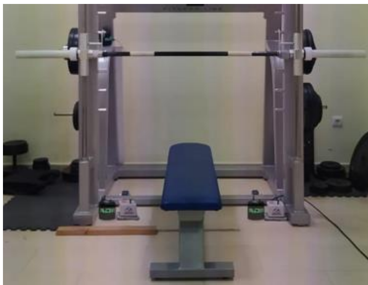
Figura 2. Distribución de los codificadores ADR y dispositivos T-Force en la barra. Extraído de Moreno-Villanueva et al (2022)
