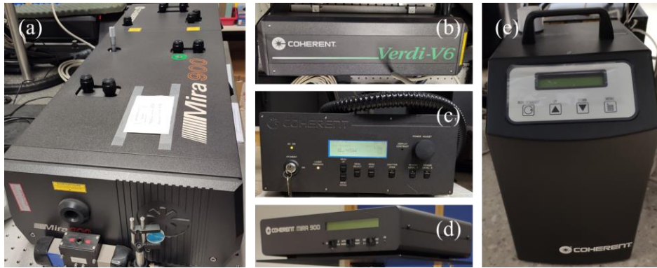
Figura 2.2. Elementos de la fuente láser de iluminación principal empleada en este trabajo: (a) láser de Ti:Zafiro; (b) láser Nd:YAG; (c) láseres diodo de bombeo; (d) controlador de la cavidad que produce el haz pulsado; (e) unidad de refrigeración.
