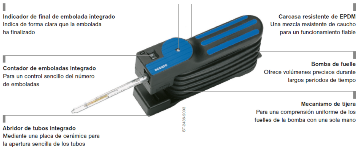
Figura 21. Conjunto de tubos colorimétricos y bomba manual accuro de Dräger para medida de formaldehído.
