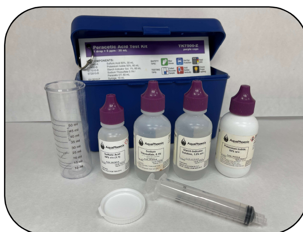
Fotografía 3.3. Kit de valoración volumétrica (Drop titration kit, AquaPhoenix Scientific).
