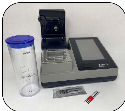
Fotografía 3.6. Sensor cronoamperométrico (Kemio, Palintest).
