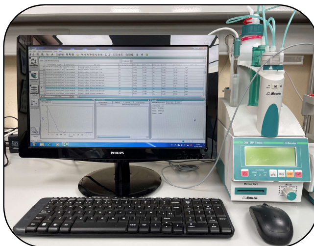
Fotografía 3.8. Valorador amperométrico (785 DMP Titrino, Metrohm).
