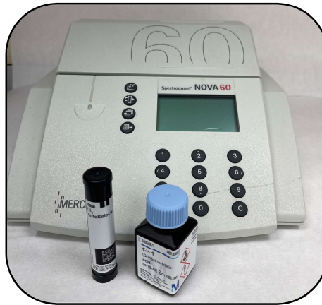
Fotografía 3.7. Método espectrofotométrico del DPD (Test cloro y Spectroquant NOVA60).
