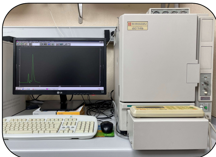
Fotografía 3.10. GC-TCD (CG-14B, Shimadzu).
