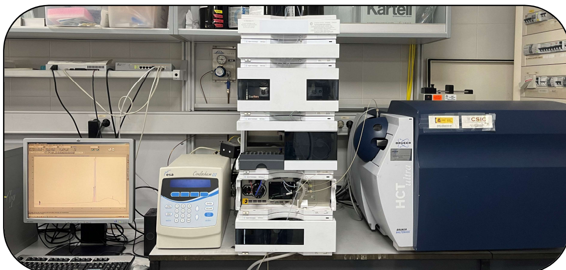
Fotografía 3.1. HPLC-DAD-ESI-IT (MSn) 1200 series (Agilent).
