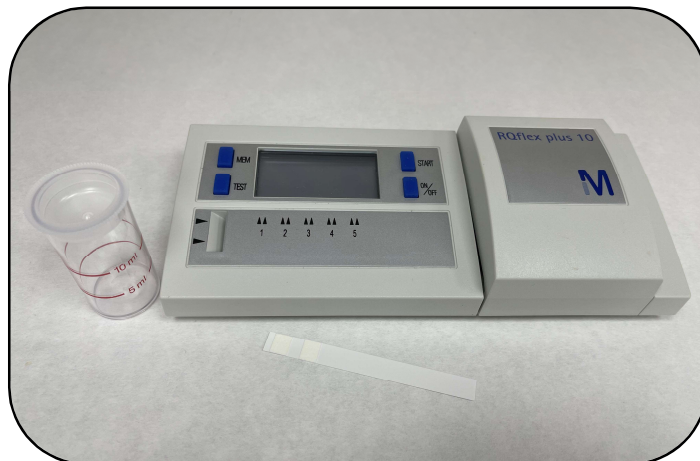
Fotografía 3.4. Reflectómetro (RQflex® 10 reflectometer, Merck).
