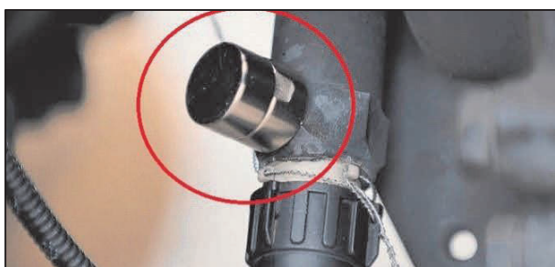
Gráfico 87. Imán de características especiales, situado sobre el sensor de movimiento del camión.
