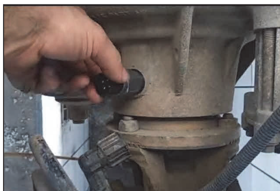
Gráfico 55. Sensor de Velocidade do Tacógrafo "com defeito" - Volvo FM 370.
