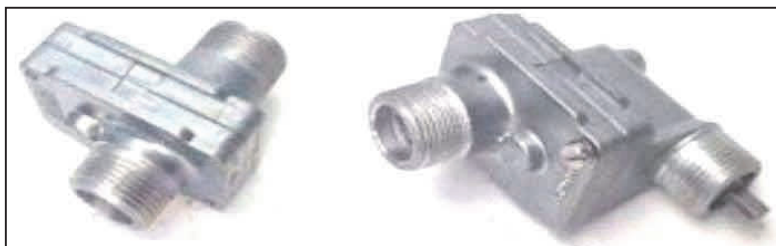
Gráfica 63. Caja adaptadora de tacógrafo analógico mecánico 594 .
