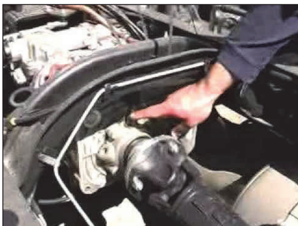
Gráfico 88. Posición real del sensor de movimiento sobre el eje motriz del vehículo (donde se apoya el dedo índice). Por su ubicación es preciso, para señalar el fraude, acceder físicamente al motor; pues no se ve a simple vista. Fuente: Elaboración propia.
